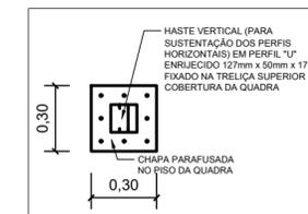
DETALHE DA FIXAÇÃO DOS PILARES
