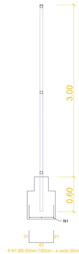
**DETALHAMENTO DA MALHA DA ARMAÇÃO**
