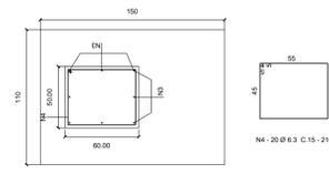
DETALHE SAPATA / PILAR CONCRETO ARMADO
