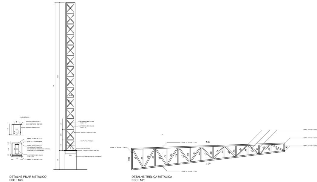
DETALHE PILAR METÁLICA
