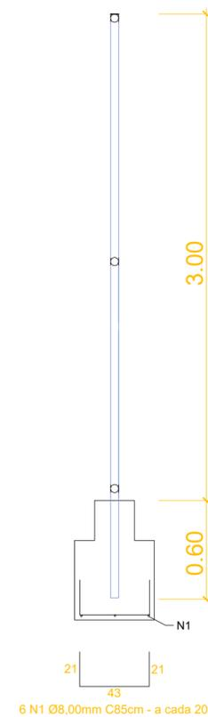
**DETALHAMENTO DA MALHA DA ARMAÇÃO**
