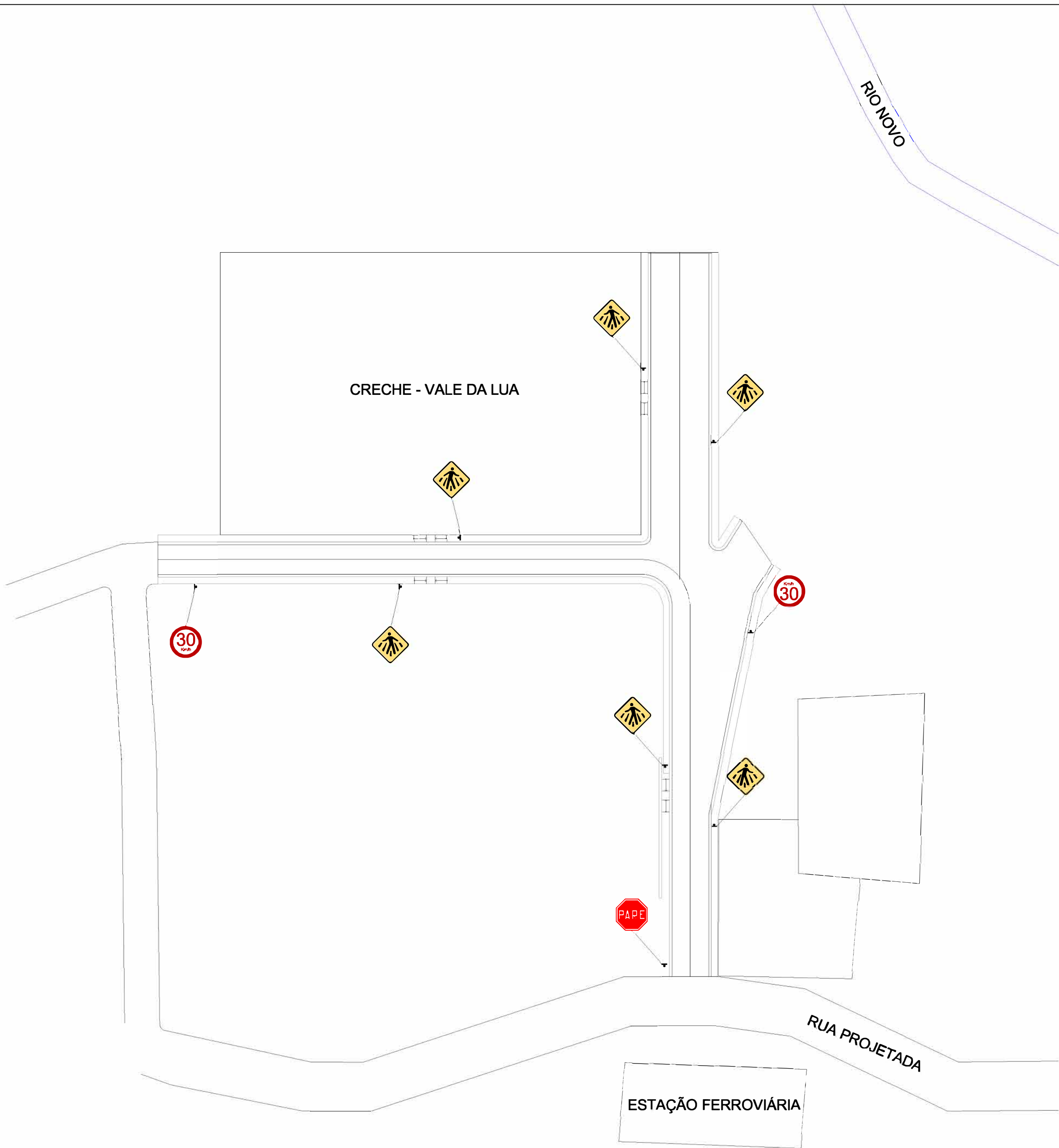
PLANTA BAIXA - SINALIZAÇÃO VIÁRIA Cotas em metro Escala - 1/400
