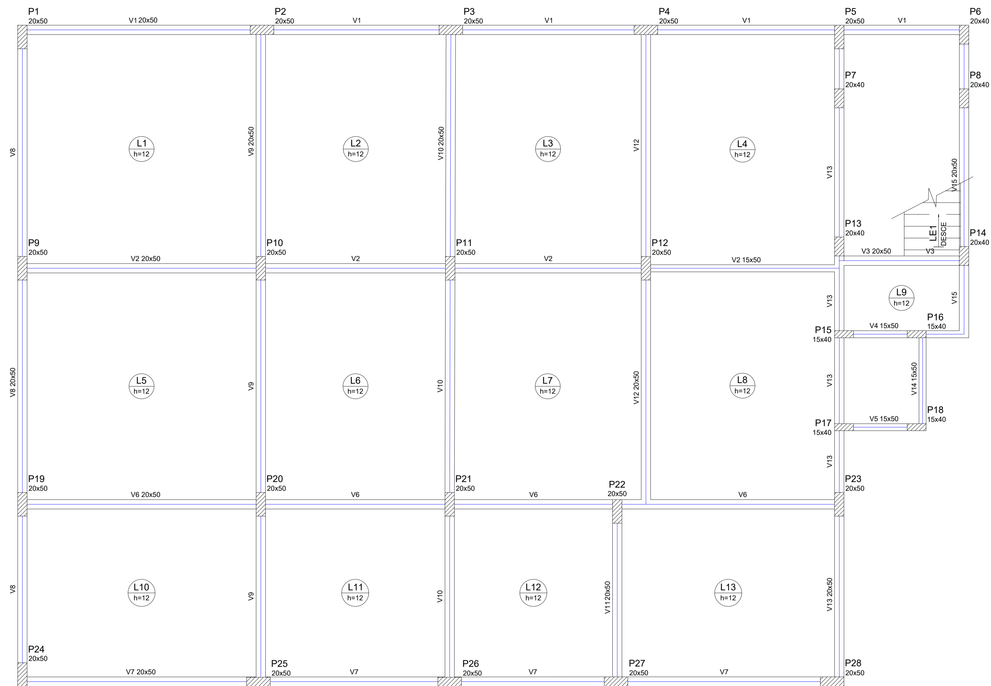
Forma do pavimento Seg. Pavimento (Nível 740) escala 1:50
