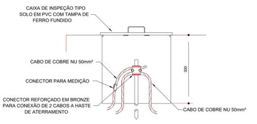
DETALHE DE INSTALAÇÃO DE CAIXA DE INSPEÇÃO TIPO SOLO COM CONECTOR DE MEDIÇÃO
