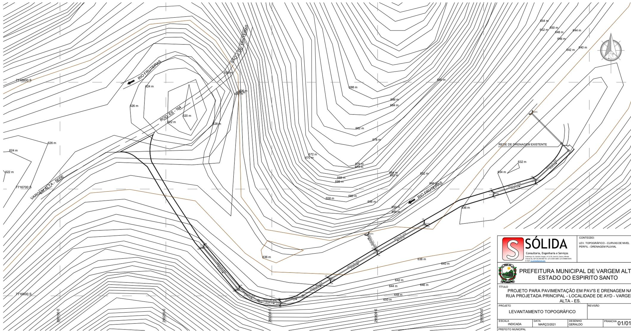
LEV. TOPOGRÁFICO - CURVAS DE NÍVEL
