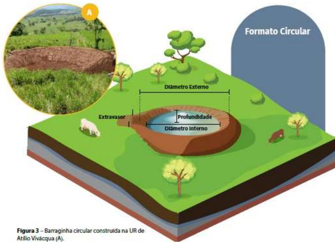
Figura 3 – Barragem circular construída na UR de Atílio Vivacqua (A). Geometria e dimensões de uma barragem circular.
