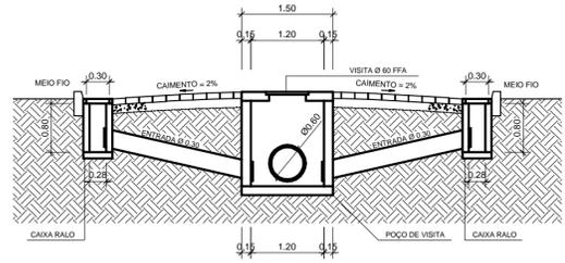
**SEÇÃO TRANSVERSAL - DRENAGEM PLUVIAL**
