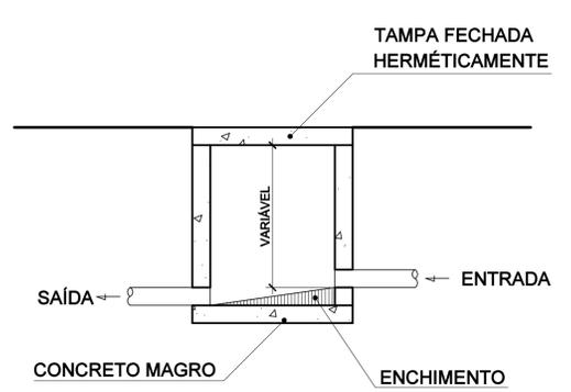
**CORTE DA CX. DE INSPEÇÃO**
