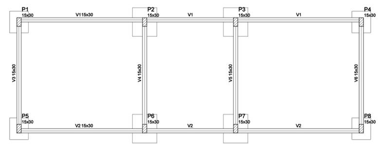
Forma do pavimento Fundação (Nível 0) escala 1:50
