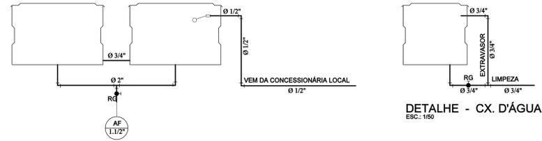
MODELO DE INSTALAÇÃO DE CX. D'ÁGUA
