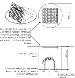
DETALHE DE INSTALAÇÃO DA CAIXA DE INSPEÇÃO TIPO SOLO COM TAMPA PARA CONEXÃO DAS MALHAS
