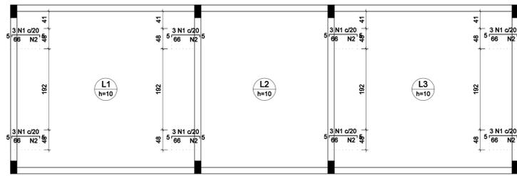
Armação negativa das lajes do pavimento Cobertura (Eixo X)
