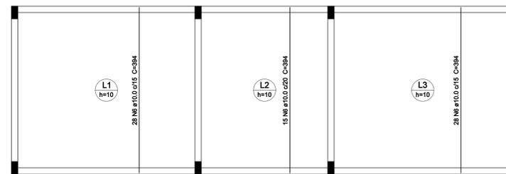
Armação positiva das lajes do pavimento Cobertura (Eixo Y)
