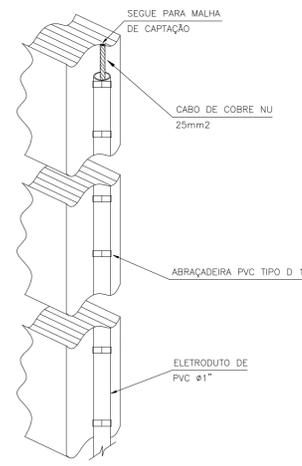
DETALHE DA FIXAÇÃO DO ELETRODUTO COM O CABO DE DESCIDA
