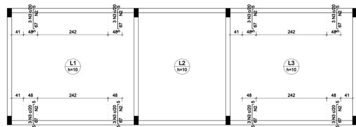
Armação negativa das lajes do pavimento Cobertura (Eixo Y)
