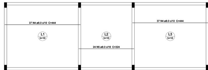
Armação positiva das lajes do pavimento Cobertura (Eixo X)
